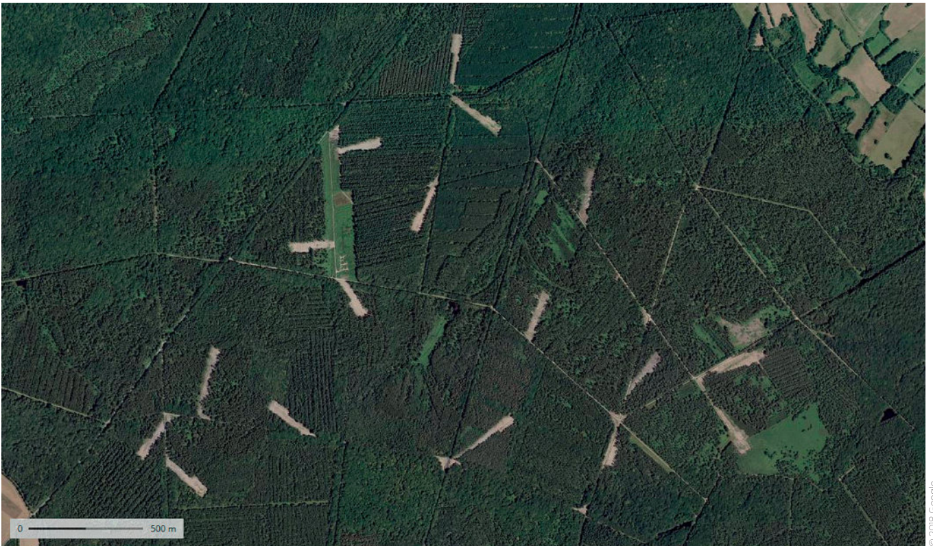
Photo 2 – Défrichage dans le cadre d'un projet éolien en Bretagne. Données cartographiques.
