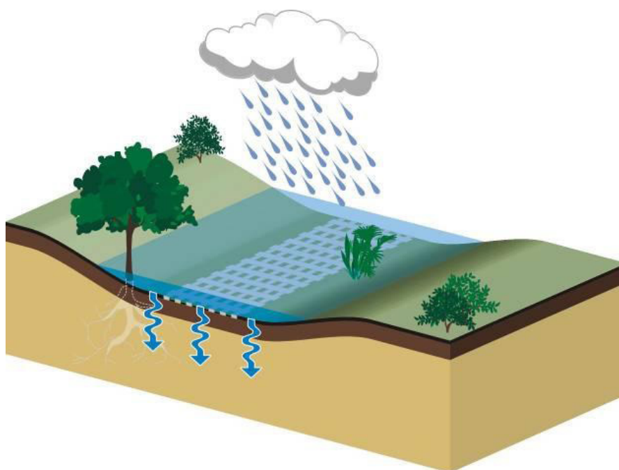
Schéma d'une noue infiltrante © Guide Bâtiment Durable
